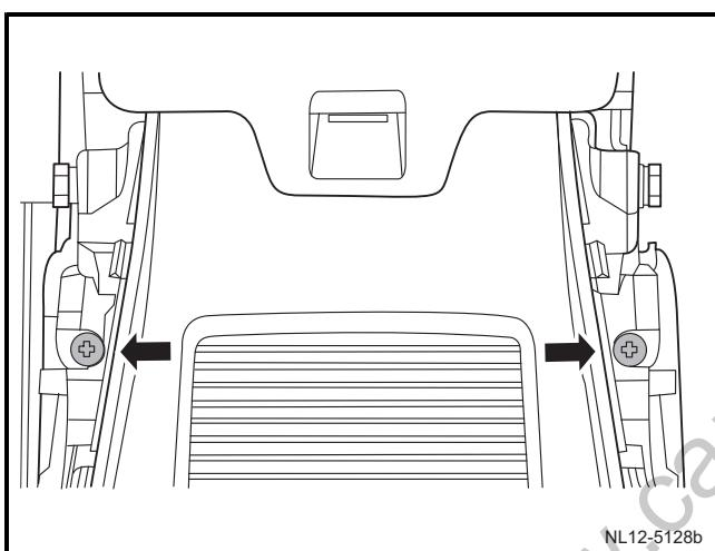
20) 拆卸副仪表板前部面板上的 2 个固定螺钉。
