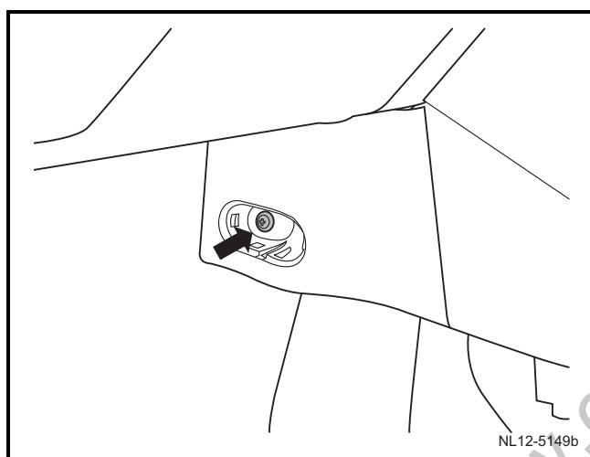
16) 接合副仪表板左前挡板背部的 2 个卡接, 安装左前挡板上的一个固定螺钉。
