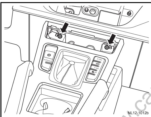
12) 安装副仪表板前端上部的 2 个固定螺钉
