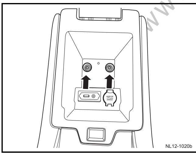
16) 拆卸副仪表台后安装点的 2 个固定螺栓。
