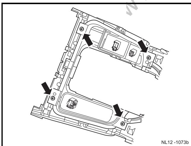
2) 安装副仪表板开关组背面的 4 个固定螺钉。
