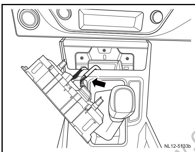
4) 连接空调控制面板线束连接器。
