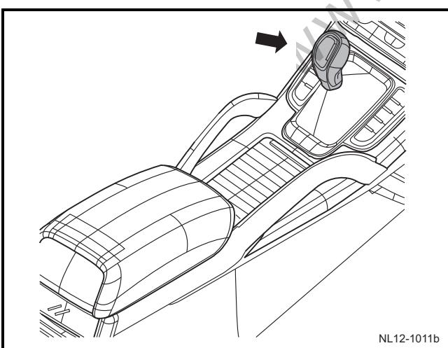
13) 安装副仪表板换挡机构装饰面板。
